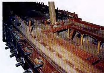
5 – Tercera batería y se están colocando los bahos sobre los que ira el tablado del último puente.
